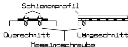
Bei diesem System werden die Gleise am Modulende mittels Messingschrauben, die unter den Gleisen angebracht werden, angelötet. Die genaue Justierung erfolgt mit der Modulendprofilschablone. Eventuelle Ungenauigkeiten werden über die Verbindungslöcher beim Zusammenschrauben ausgeglichen.
