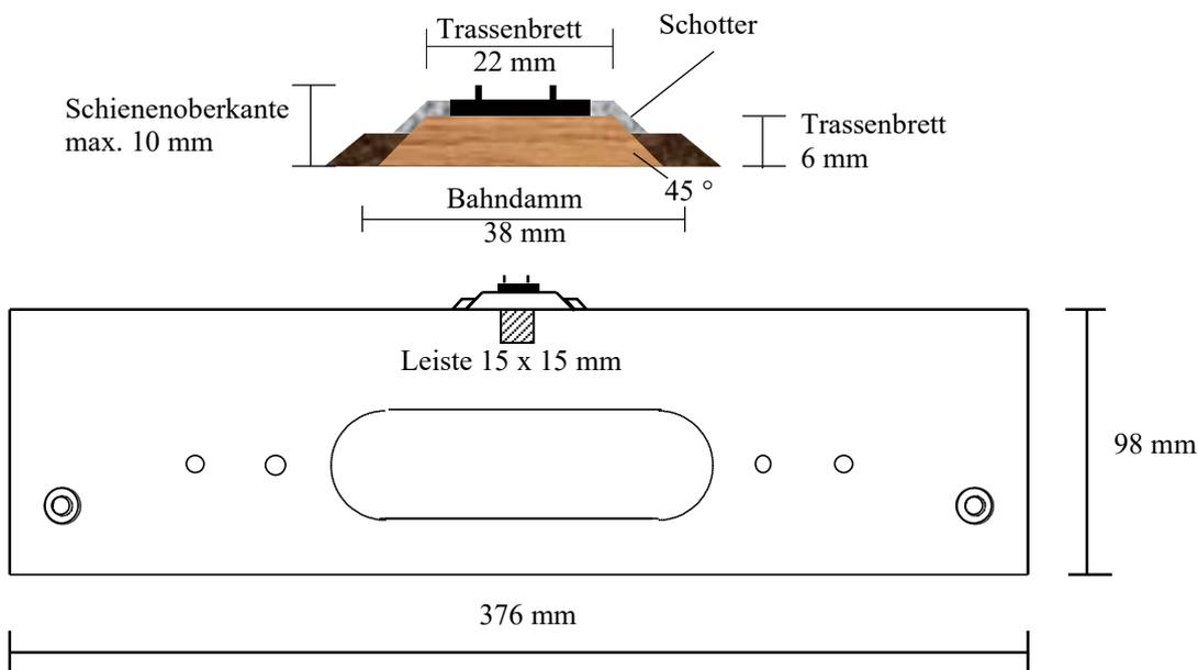
Ansonsten gelten dieselben Normen und Materialien (12 mm Sperrholz für Modulkastenteile und 6 mm Sperrholz für Trassenbrett) wie bei den zweigleisigen Hauptbahnmodulen.
