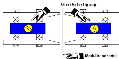
Beim System A („Prinzip Leo“) werden die Gleise mittels Schrauben am Modulende festgehalten. Dieses System hat den Vorteil, dass evtl. Ungenauigkeiten am Modulende wegen des verschiebbaren Teils ausgeglichen werden können.
