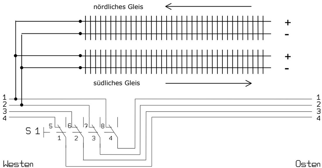
*Gleisanschluss im digitalen Betrieb*
