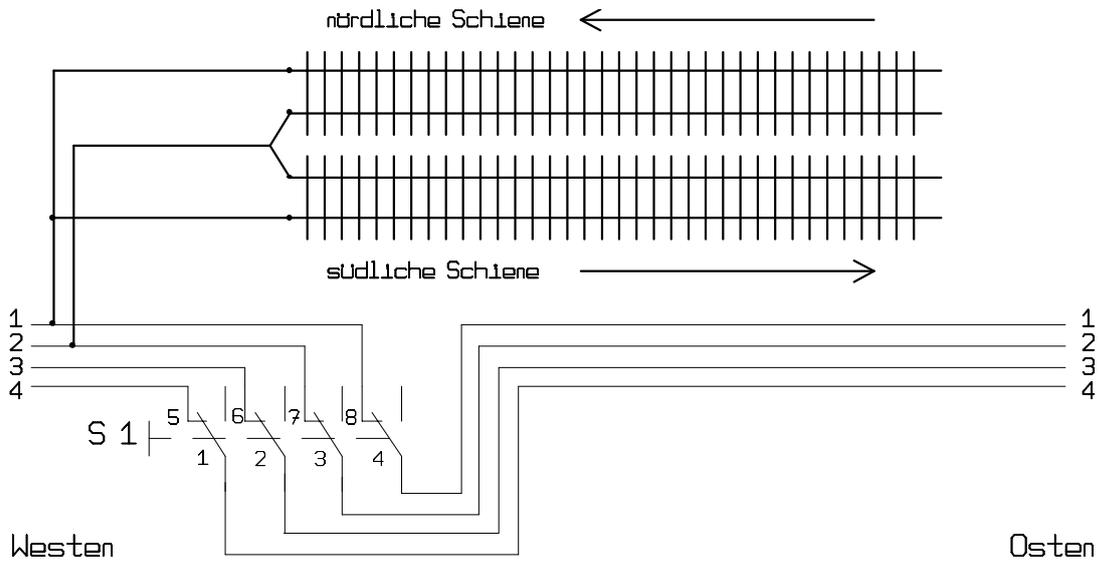
*Gleisanschluss im analogen Betrieb*
